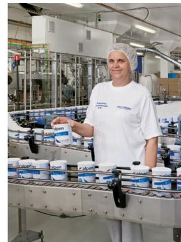
*Dosenlinie Babynahrung. Jede Produktion untersteht einer kritischen Endkontrolle. Kontrolliert werden beispielsweise Deckel, Boden und die verschiedenen Beschriftungen.*
